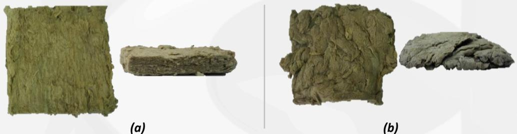
Apariencia del Material Aislante Antes (a) y Después (b) de ser Afectado por Humedad.
