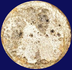
Superficie de Biocupon con picaduras a 30x.
